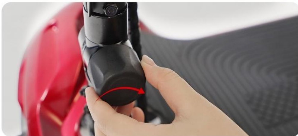
Rys. 4. Luzowanie pokrętło regulacji dźwigni sterującej
