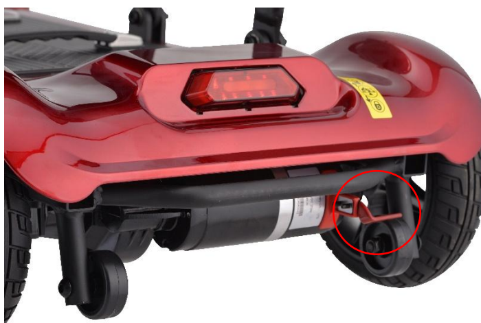
Rys. 8. Ręczne i automatyczne przełączanie dźwigni sterującej hamulcem
