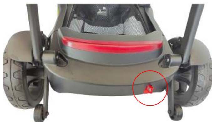
Rys. 7. Ręczne i automatyczne przełączanie dźwigni hamulca
