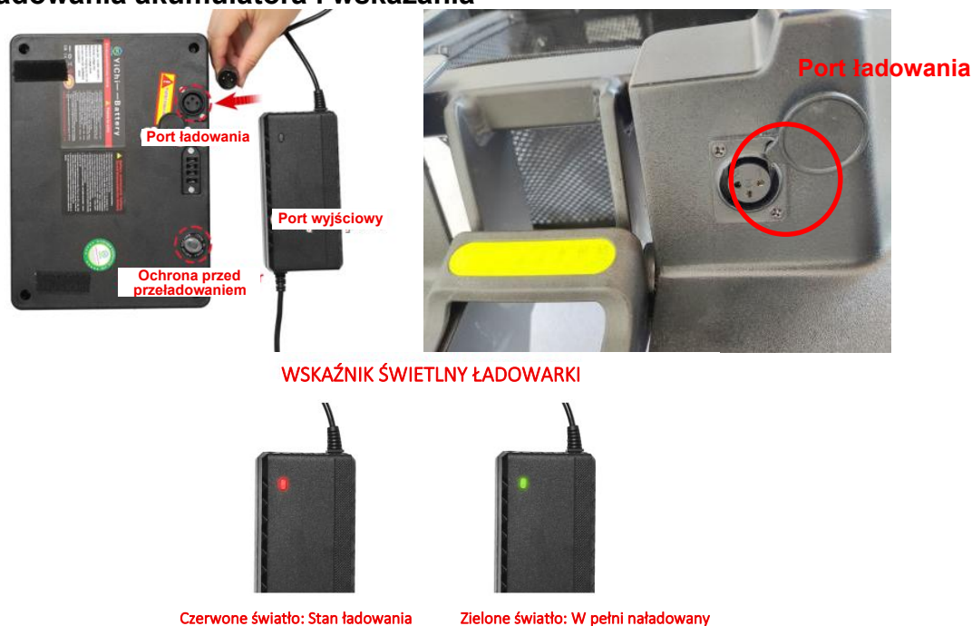
Rys. 4. Podłączenie ładowania i wskaźnik świetlny
