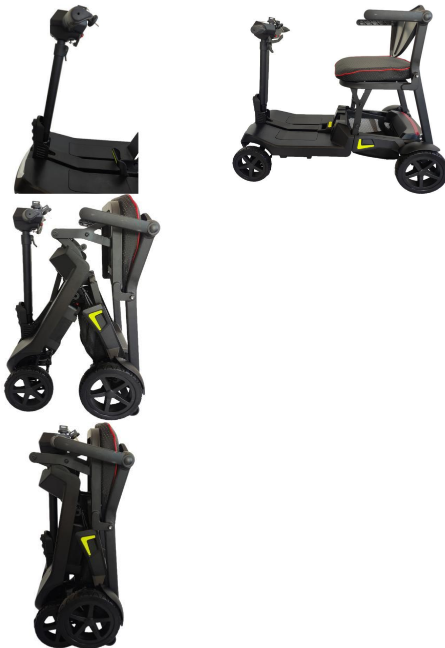
Rys. 10. Etapy składania skuteru
